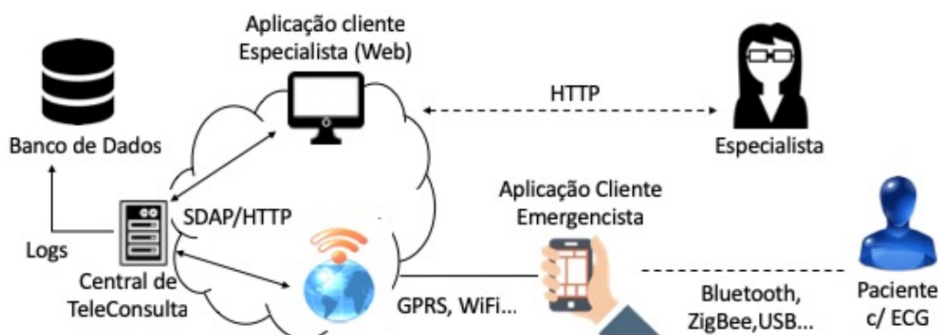
Figura 3 - Visão geral do sistema AToMS
