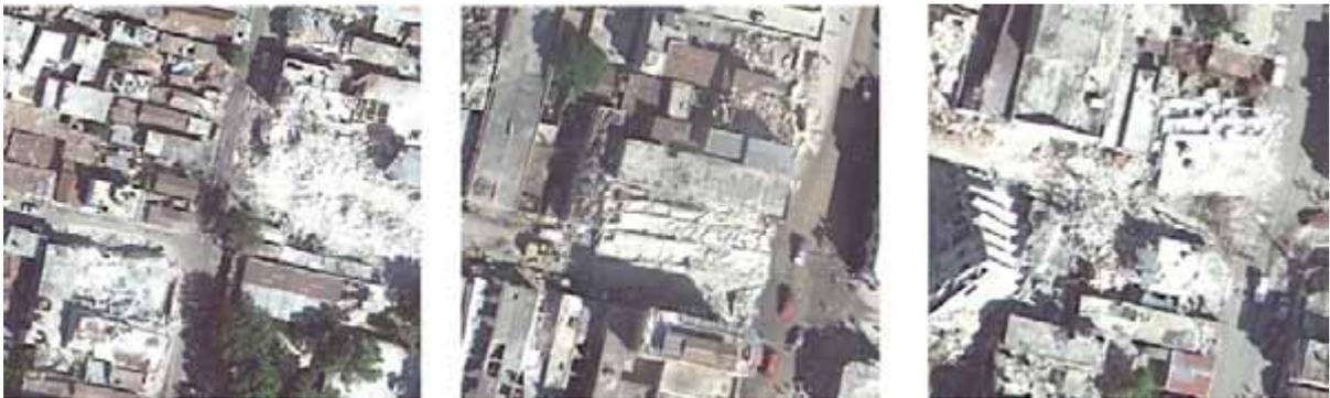
Figura 3: Da esquerda para a direita: exemplo de ruas levemente, moderadamente e severamente bloqueadas.
