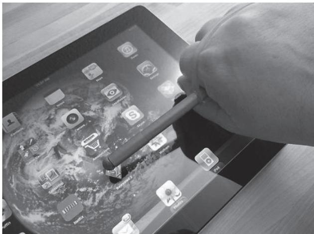
**Figura 2.2. Dispositivo sobre a tela de um tablete que, quando fixado à mão do usuário, facilita o acionamento da tela sensível ao toque.**
