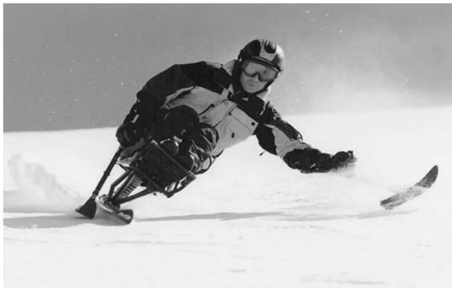
**Figura 2.4. Dispositivo 4, fixado aos membros inferiores de uma pessoa com paraplegia e desenvolvido para auxiliá-lo na prática do esqui.**
