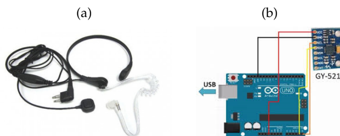
Figura 11 – Equipamentos para a aquisição de dados: (a) laringofone usado para capturar os sinais sonoros gerados durante o processo de deglutição; (b) placa de acelerômetro e giroscópio usada para capturar os movimentos gerados durante o processo de mastigação.
