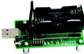
Figura A.1: Estação base MIB520 com módulo MICAz acoplado (MEMSIC, 2010a).
