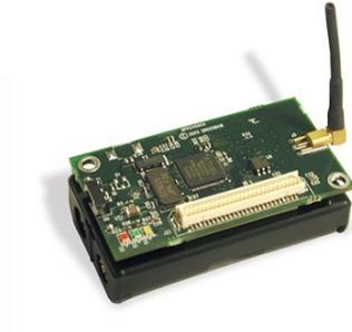
Figura 5.1: Nodo sensor com a plataforma MICAz.
