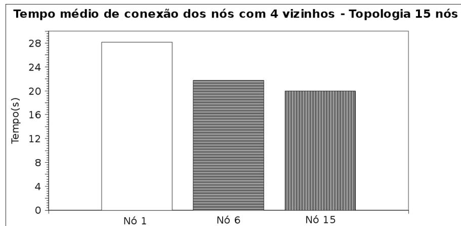
**Figura 25:** Tempo médio de conexão dos nós com 4 vizinhos na rede com topologia de 15 nós - LMP-strict.
