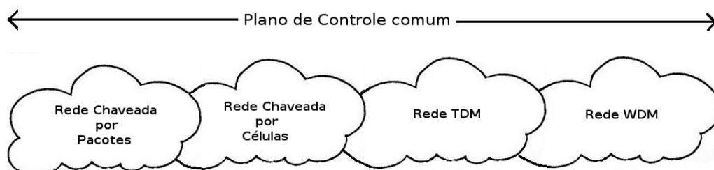
O MPLS possui especificações dos planos de controle e de dados, porém, o GMPLS somente se preocupa com o plano de controle. O GMPLS suporta provisionamento de canais óticos em tempo real, incluindo roteamento dinâmico, emprega versões estendidas dos esquemas de sinalização e roteamento desenvolvidos para engenharia
