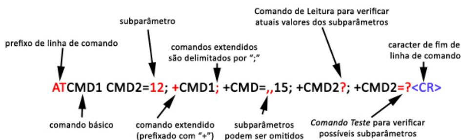
Figura 4.14: Estrutura de uma linha de comando AT. Fonte: Adaptada de (ETSI, 1999)
