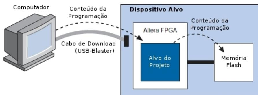
Figura 4.11: Esquema de *download* dos Projetos de Hardware e Software. Fonte: Adaptada de (ALTERA, 2010d)
