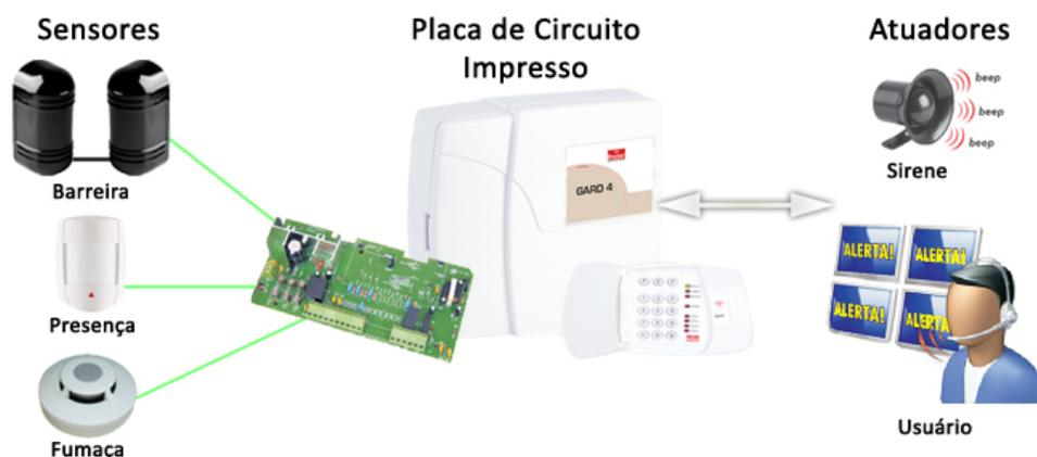
Figura 4.1: Modelo Convencional de uma Central de Alarme
