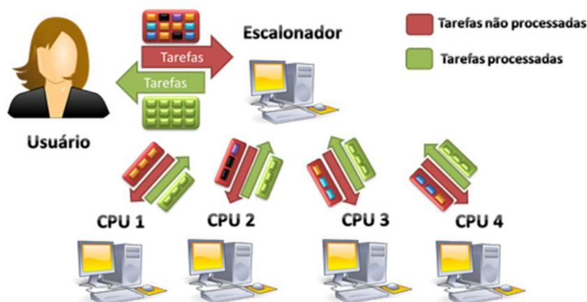
Figura 1 - Exemplo de funcionamento de uma grade computacional.
