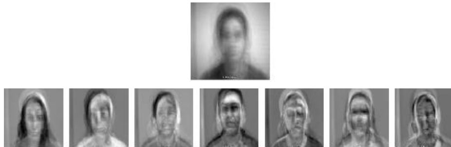
Figura 16 - Exemplo de face média (acima) e Eigenfaces mais importantes no treinamento.
