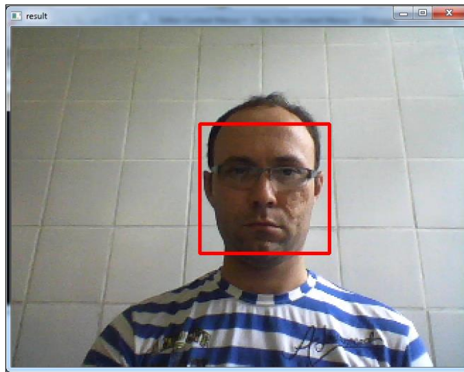
Figura 33 – Execução do algoritmo de detecção de face Viola-Jones em um vídeo. Fonte própria.
