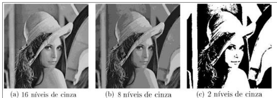
Figura 4 – Variação de profundidade de uma mesma imagem (FALCÃO e LEITE, 2003).
