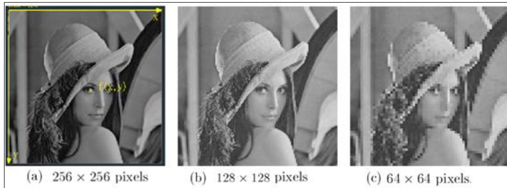
Figura 3 – Variação de resolução espacial de uma imagem com 256 níveis de cinzas (FALCÃO e LEITE, 2003).
