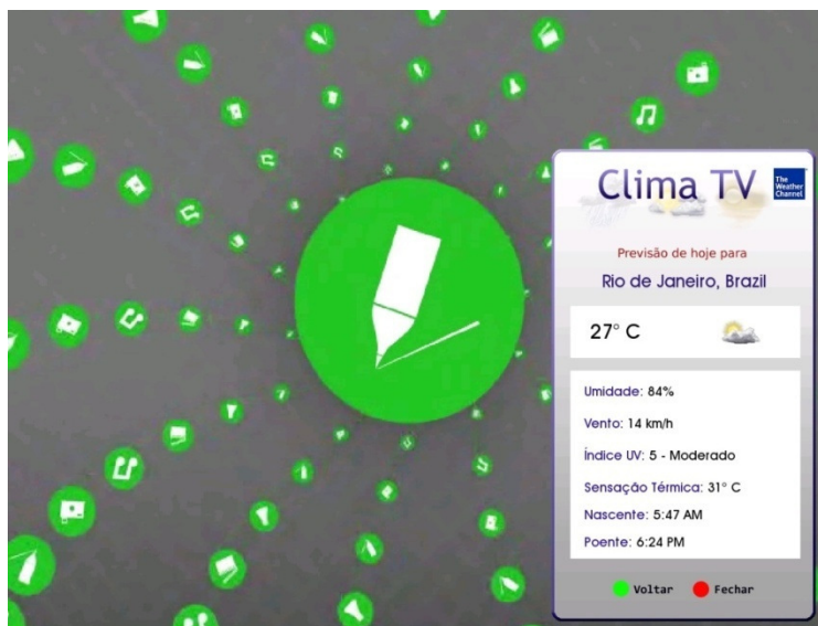
Figura 13 - Aplicação Clima TV com necessidade de canal de retorno dedicado.
