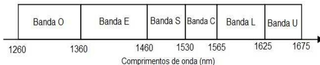
Figura 2.2: Longa faixa espectral de comprimento de onda das fibras de espectro completo.
