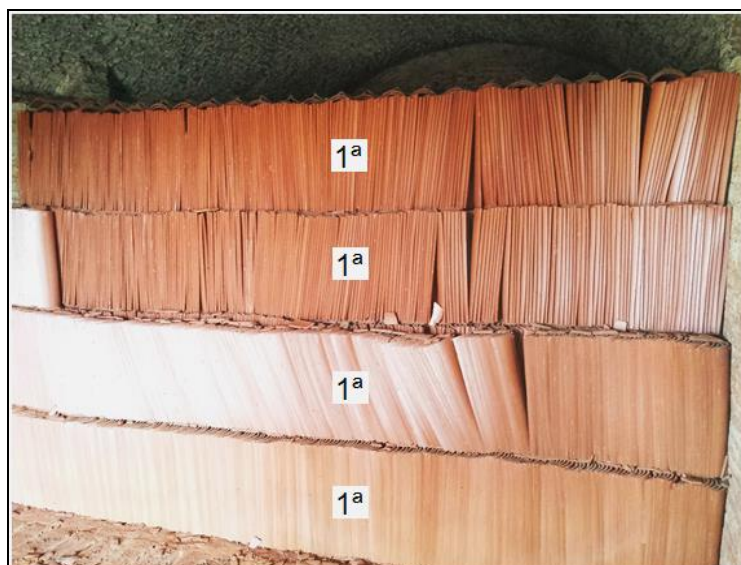
Figura 84 – Início do forno com o sistema microcontrolado inteligente e funcionários atingindo 100% de telhas de 1ª qualidade.
