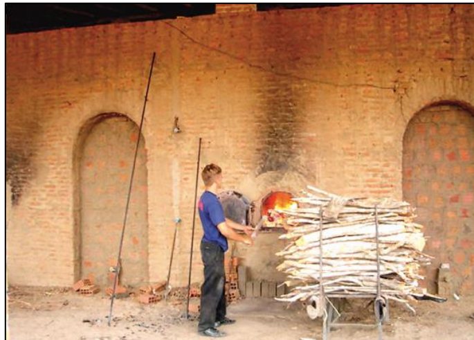
Figura 33 – Processo de sinterização em forno a lenha.
