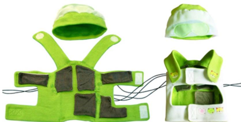
Figura 18 – Equipamento desenvolvido para monitoramento de recém-nascidos.
