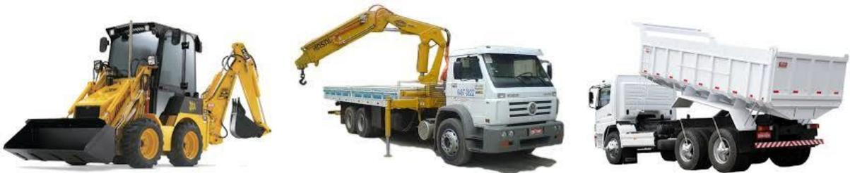
Figura 06 – Tipos de maquinários para escalonamento. (A) Retroescavadeira, (B) Caminhão Munck, (C) Caçamba.
