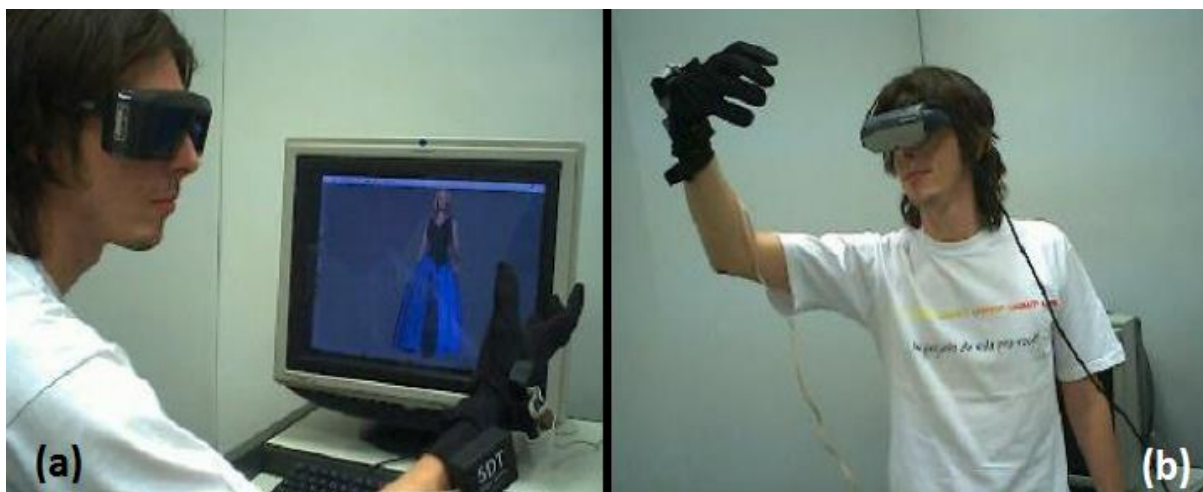
Figura 1 – (a) Exemplo de RV não imersiva utilizando monitor (b) Exemplo de RV imersiva utilizando capacete de imersão
