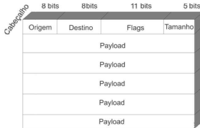
**Figura 7. Formato do pacote da NoCX4. Adaptada de (OLIVEIRA et al. 2010).**
